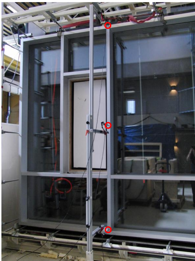
De røde cirkler indikerer punkterne, hvor deformationerne er målt.
