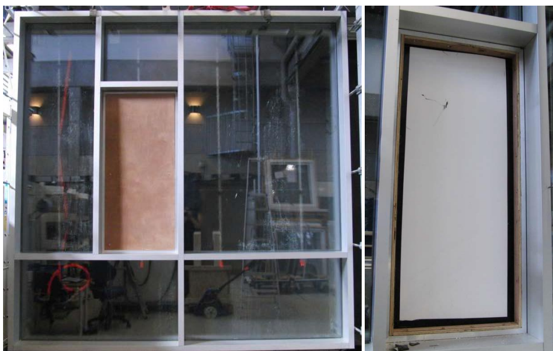
Facadeelement under prøvning samt fastgørelse af plade til vinduessimulering
